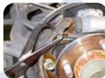
Projeto especial para posicionar e remover a mola do tambor de freio
