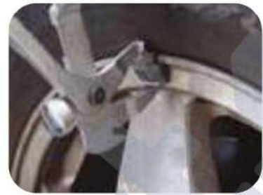
Fixa e remove os pesos de balanceamento
