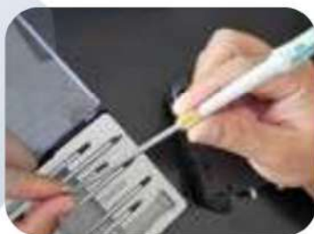
Encaixe na empunhadura e aperte com a porca de ajuste
