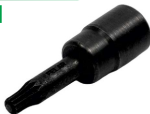
Chave soquete estriado de 8mm com encaixe de 1/2" para parafusos da homocinética.
