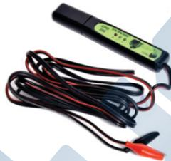
Caneta Teste de Polaridade 12/24VDC com 2 Leds Ultra Brilho de Iluminação com cabo de 3 metros. Verifica oscilação +/-, identifica polaridade negativa (-) ou positiva (+) e etc. É indicada para reparos e manutenção de automóveis, motocicletas, tratores, caminhões, caminhonetes, etc.
