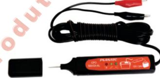
Caneta Teste de Polaridade (Alta Impedância) 12/24VDC com 2 Leds Ultra Brilho de Iluminação com cabo de 3 metros. Verifica oscilação +/-, identifica polaridade negativa (-) ou positiva (+) e etc. Não interfere no funcionamento do motor (não gera ruídos nos sistemas embarcados - CAN).
