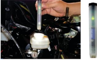
Teste de fluido de freio (modelo portátil tipo "caneta") DOT 3 // DOT 4, no intuito de identificar a umidade ou água no sistema de freio.
