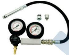
Medidor de vazão de cilindro de motores com válvula reguladora, possui manômetro de pressão com escala de 150Psi e 10Bar, manômetro de vazão e conexões com engate rápido.
