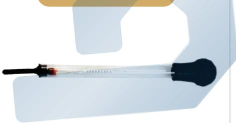
Teste bateria por densidade, utilizado para analisar a bateria através de sua composição, indicando necessidade de carga, 1/2 carga e carregada.
