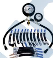
Equipamento de teste de pressão e vazão simultânea da bomba elétrica de combustível para veículos com injeção eletrônica, manômetro de aço inox de 4" com escala de 0 a 12 Bar com glicerina, manômetro de aço inox de 62mm com escala de 200 L/H, sistema de alívio através de registro. Acompanha jarra graduada (1 litro), disponível com 17 mangueiras.
