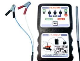
Teste de fluido de freio DOT 3 // DOT 4 // DOT 5, no intuito de identificar umidade ou água no sistema de freio.
