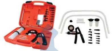
Bomba Manual de Vácuo/Pressão analisa tubulações do sistema de freio e combustível, ar falso, avanço a vácuo no carburador, testa servo freio a vácuo, sensores da injeção eletrônica, vazamento em anéis, válvulas e juntas, efetua sangria de freio. Acompanha adaptadores.
