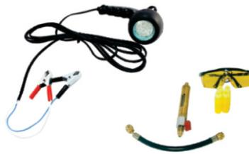
Identificador Ultravioleta de Vazamento de gás de ar condicionado. Combina o contraste com a lâmpada ultra-violeta adequada, desta forma ele é capaz de localizar com precisão vazamentos (R12 e R134) no sistema de refrigeração, radiadores, também usado em radiadores e misturado ao óleo do motor para identificar bloco trincado.
