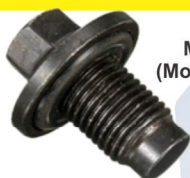
M14X1,5X21,5 (Modelo ORIGINAL) Nº ORIGINAL F6TZ-6730/BA FORD KA/FIESTA/CURRIE ZETEC ROCAM 99/... RANGER MOTOR 2.2 E 3.2 DURATORQ - NOVO TROLLER 3.2 5 CILINDROS (Chave 13mm)
